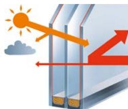
SolarEnergyGlas nutzt das Sonnenlicht für zusätzliche Wärme. Und mit einem  $U_g$ -Wert von 0,6 W/m<sup>2</sup>K bleibt die Kälte draußen.
